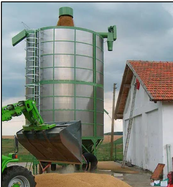
Slika 2.2-3. Sušara za žitarice model STRAHL AS 2250 TURBODRY (preuzeto s mrežne stranice: Agriexpo.online , 2020.)
